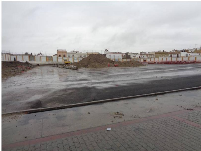
La cancha está construida por aglomerado bituminoso, y en el perímetro solera de hormigón, y pavimento de adoquines de hormigón.
