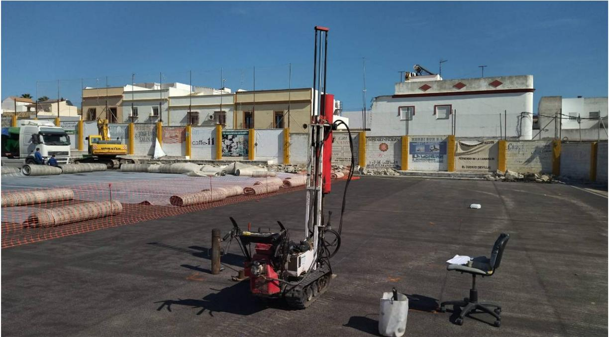
Emplazamiento del ensayo penetrométrico DPSH reseñado como P-3.
