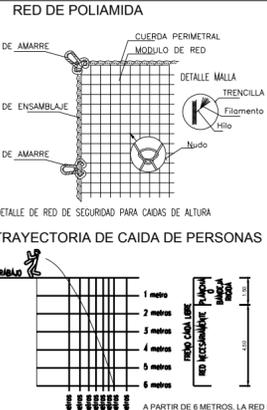
**RED DE PROTECCION PARA CAIDAS EN FASE DE ENCOFRADOS**
