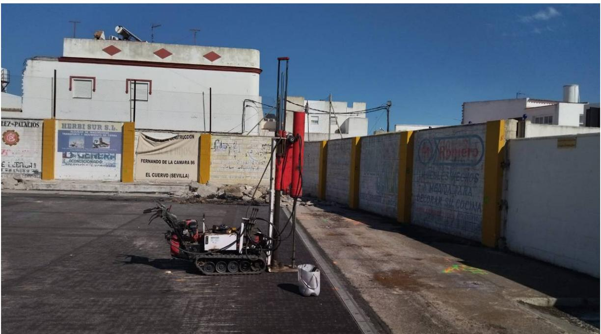
Emplazamiento del ensayo penetrométrico DPSH reseñado como P-4
